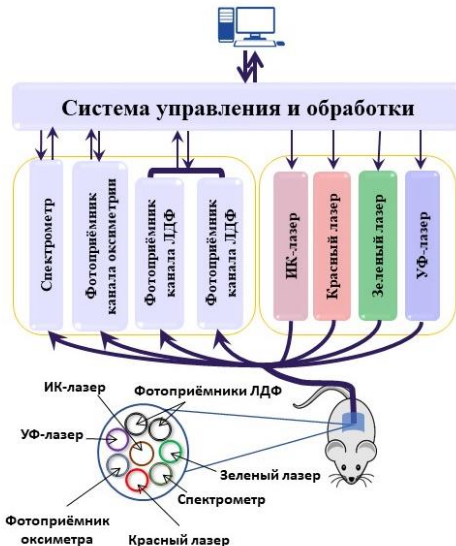
Рис. 2.3. Принципиальная схема диагностического комплекса ЛАКК-М
